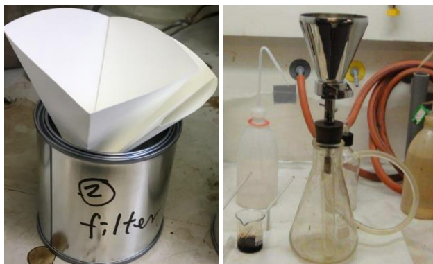
Figuur 4. Snelle terugwinning van het bitumen voor FTIR: filtratie van vloeistoffen met traditionele (links) en vacuüm opzet (rechts)
